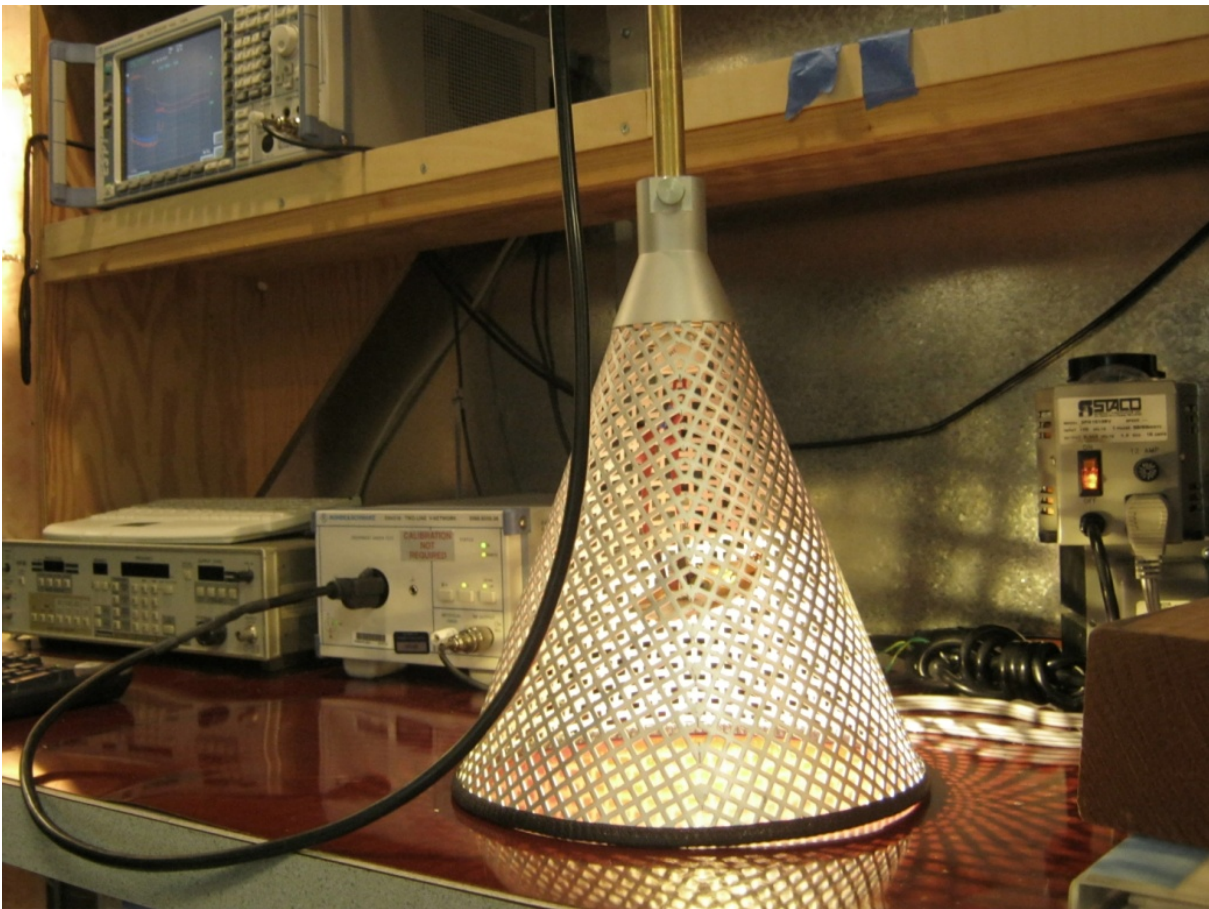
图57 – EMI测试设置 - 根据CISPR 15 / IEC: 2005标准，驱动器和LED负载被放置在一个圆锥形金属壳体内
